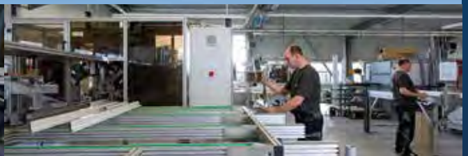
Roboterassistierte vollautomatische Verglasung für hohe Präzision und Fertigungsqualität
