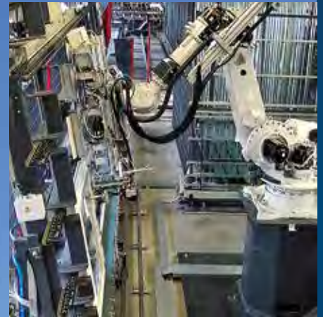
Roboterassistierte vollautomatische Verglasung für hohe Präzision und Fertigungsqualität
